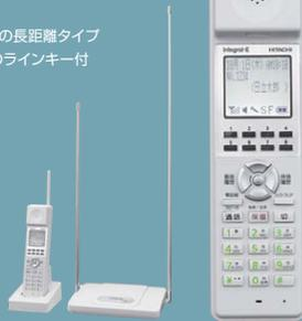
\*1 本装置は小電力コードレスシステムであり、親機と子機の電波の届く距離は周囲の環境によって異なります。小電力コードレスシステムではその距離は最大100m程度ですが、本装置では受信アンテナの感度を上げることでより広い範囲で利用できるよう工夫しています。最も条件の良い状態では最大300m程度までの通話も可能ですが、コンクリート壁や金属の扉、立ち木などの障害物および電線環境によって距離が短くなることがあります。お使いになる前に使用範囲をお確かめください。
